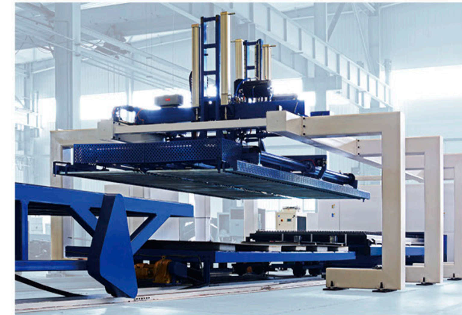
Saugerbrücke zur Beladung / Rechensystem zur Entladung Urządzenie próżniowe do systemu ładowania / rozładunku
